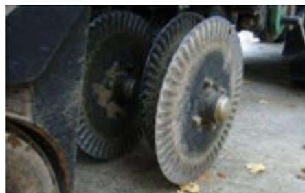
Détail de la roue de fermeture
