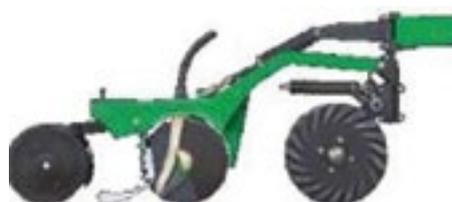
Détail de l'ensemble disque ouvreur, semeur et roue de fermeture
