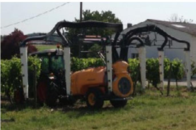
Trainé 1500 litres, pneumatique 6 faces traitées, rampe pendillard Flexispray, DPAE.
